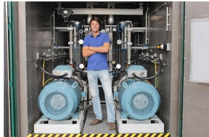
Бустерный модуль с насосами API610 и буферной системой под давлением для двойного механического уплотнения
